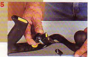
5. Pour "donner du fer" (sortir la lame), tourner le bouton moleté dans le sens des aiguilles d'une montre. Pour "retirer du fer" (rentrer la lame), tourner le bouton dans l'autre sens.
