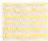
Papier silex (papier de verre). Abrasif le plus ordinaire, pour les ponçages courants sur bois, plâtre, peintures...
